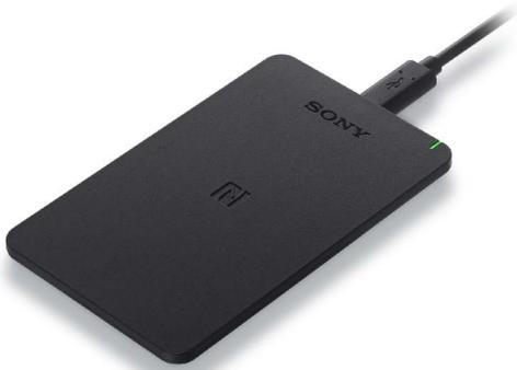
RC-S300/S1はFeliCa™カードやマイナンバーカードとの通信が可能なUSB対応のリーダー/ライターです。RC-S380/SおよびRC-S300/Sと互換性を保ち、macOSやHPKIカードの読み取りに対応しています。また通信状態を確認できるようにLEDを搭載しています。
